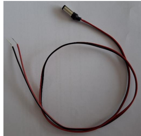
Figure 10 Insertion de l'alimentation à l'aide du connecteur cylindrique
